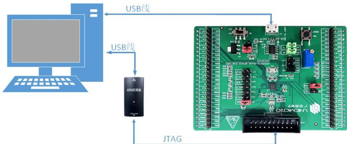
图 1-1：芯片开发硬件连接示意图
