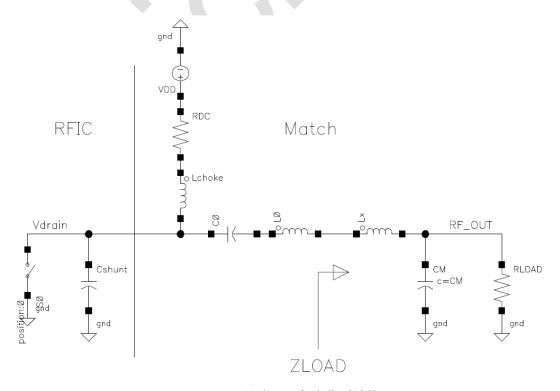
图 5-1: 开关类 PA 电路典型结构
