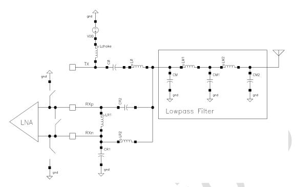
图 5-2: TX、RX 直连匹配典型结构
