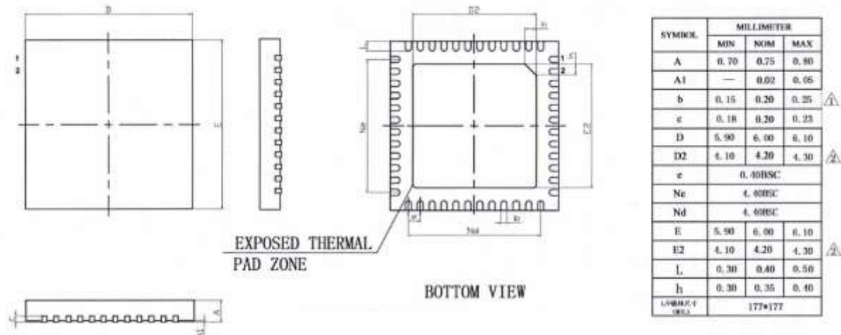
图 5-4: QFN48 (6\*6mm) 封装尺寸图
