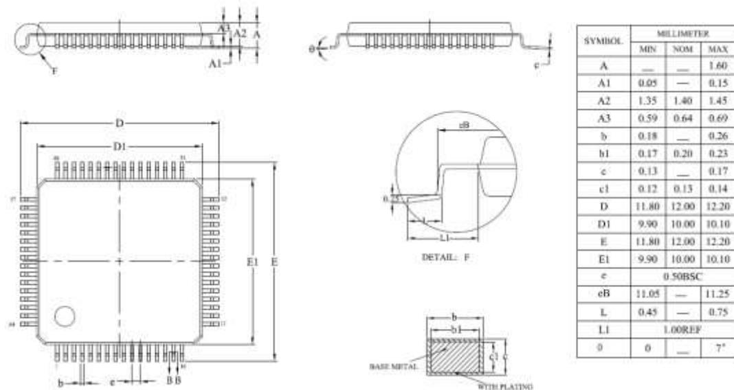
图 5-1: LQFP64 (10\*10mm) 封装尺寸图
