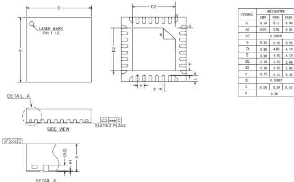
图 5-6: QFN32 (4\*4mm) 封装尺寸图
