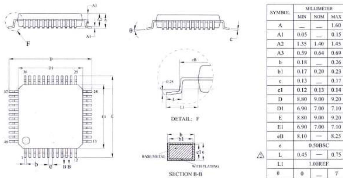
图 5-3: LQFP48 (7\*7mm) 封装尺寸图
