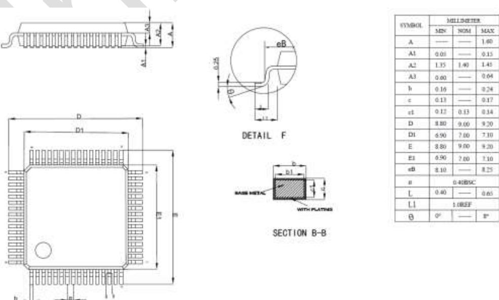
图 5-2: LQFP64 (7\*7mm) 封装尺寸图
