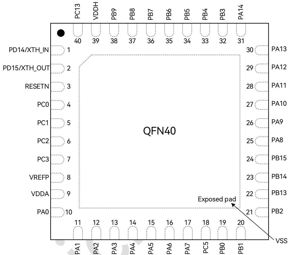
图 3-5: QFN40 (5\*5mm)引脚分布图
