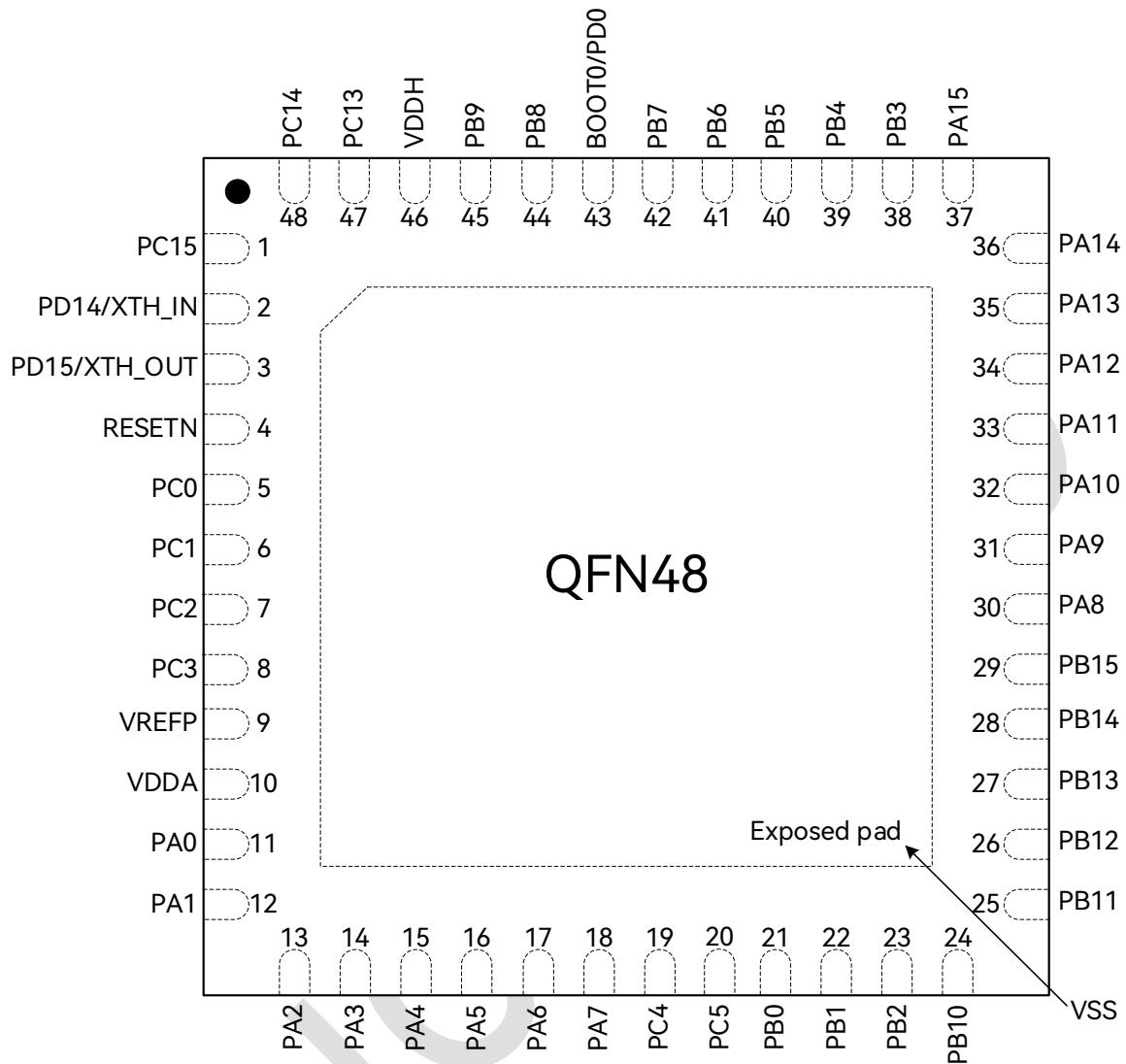
图 3-4: QFN48 (6\*6mm) 引脚分布图
