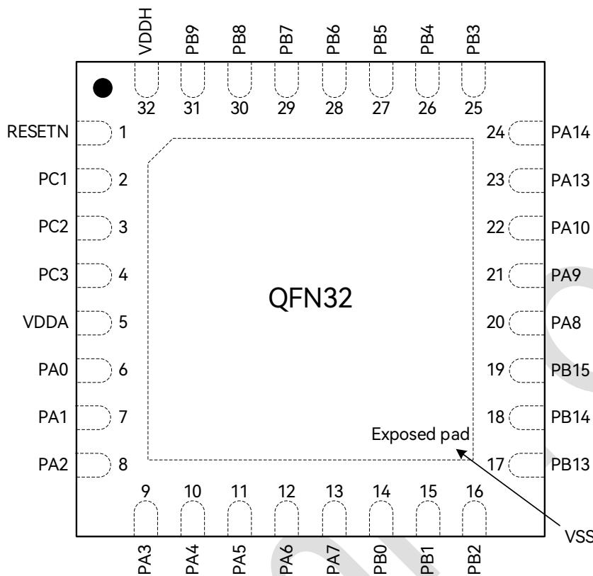
图 3-6: QFN32 (4\*4mm) 引脚分布图
