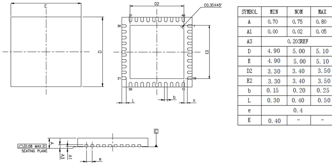
图 5-5: QFN40 (5\*5mm) 封装尺寸图
