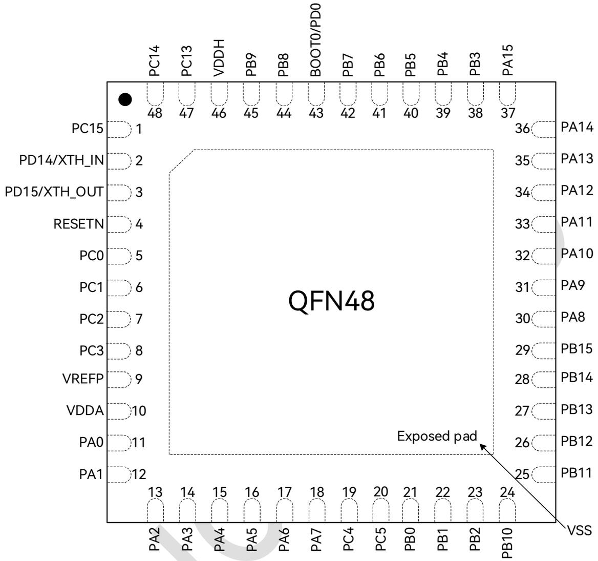
图 3-4: QFN48 (6\*6mm)引脚分布图
