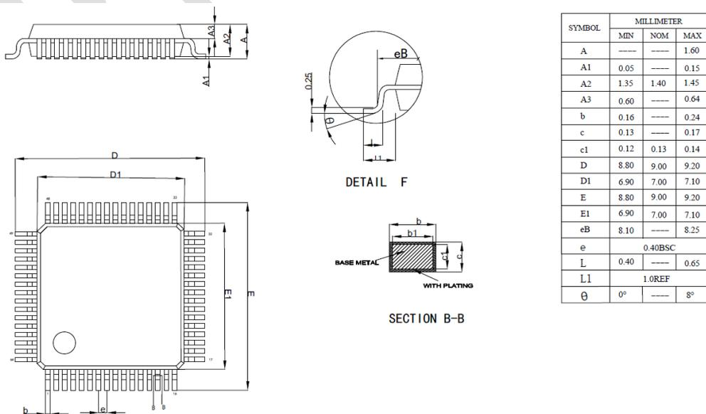
图 5-2: LQFP64 (7\*7mm) 封装尺寸图
