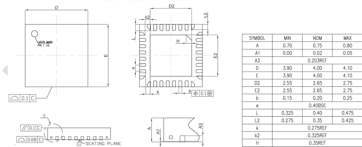
图 5-6: QFN32 (4\*4mm) 封装尺寸图
