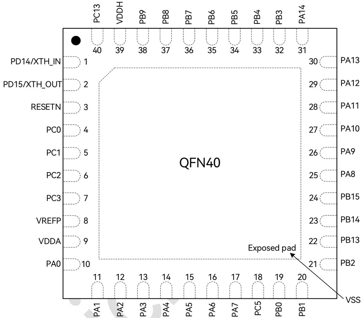
图 3-5: QFN40 (5\*5mm)引脚分布图
